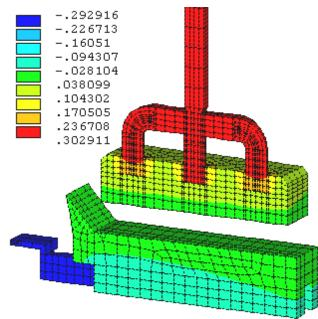
Figure 4: 3D full cell slice model equipotentials
